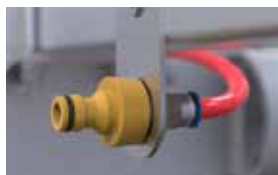
Spylesystem for rengjøring av trommel. Alle modeller har vanntette hjullager
